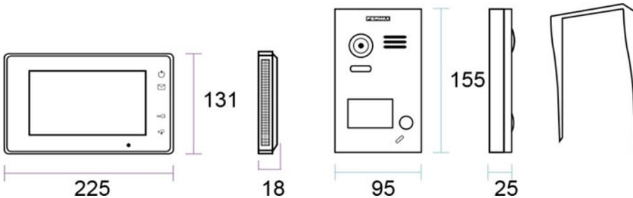
Le kit Way inclut une platine de rue fabriquée en zamak qui contient une caméra couleur CCD haute sensibilité. Installation en saillie.
