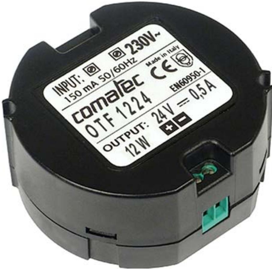
Conforme à la norme VDE 0551, classe 2 (double isolation) résistance aux courts-circuits par TCP (coefficient positif de température).
