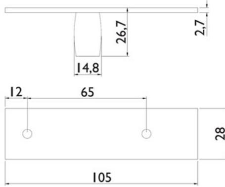
À utiliser en combinaison avec penture inférieure PT20 (FG 128005).
